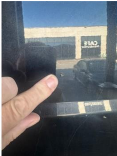
1.3 Steinsprut i dør høyre foran. Pusses og lakkeres forenklet.
