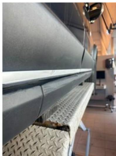
1.4 Noen riper i nedre del av dør/dørstokklist høyre side
