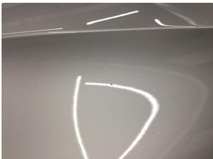
1.1 Noen små steinsprut i panser
