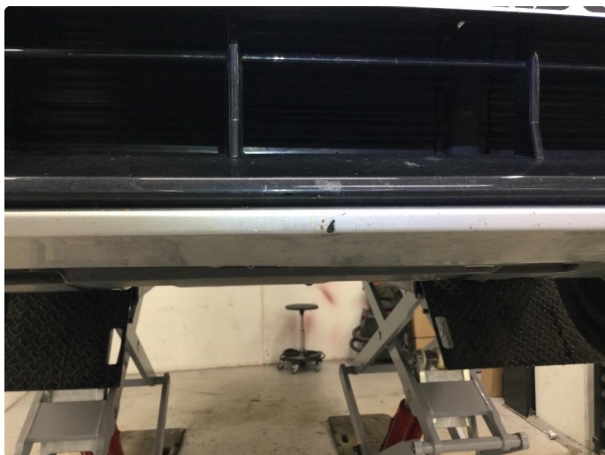
1.4 Noen små hakk i fanger foran + noe steinsprut
