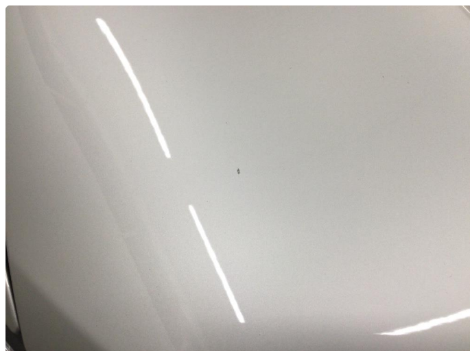
1.1 Noen små steinsprut i panser
