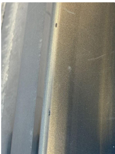
1.2 Noen små hakk i lastesone på fanger bak
