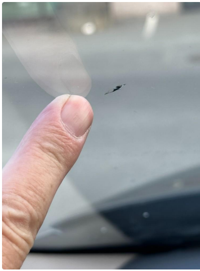
1.6 Liten steinsprut i frontrute, limes
