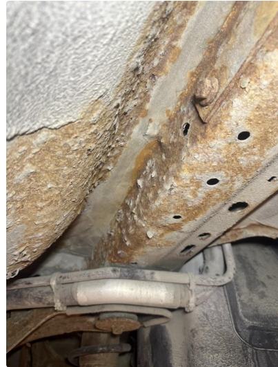
1.3 Noe korrosjon under bil
