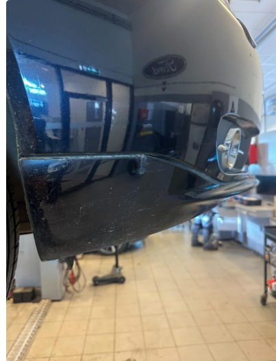
1.5 Riper på støtfanger bak
