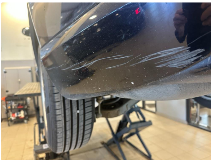
1.5 Riper på støtfanger bak
