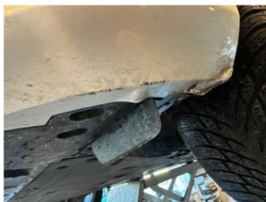
1.3 Liten ubetydelig skade på fanger nedre del venstre foran
