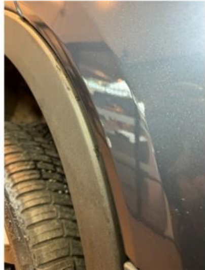
1.2 Liten lakkskade på høyre bakskjerm
