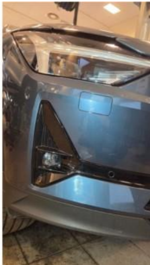
1.1 Lakkskade på høyre side av støtfanger foran
