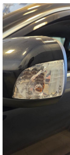
2.1 Noe krakelering i plast på blinklys begge speil
