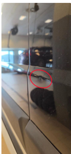
1.1 Små bulker på høyre sidedør
