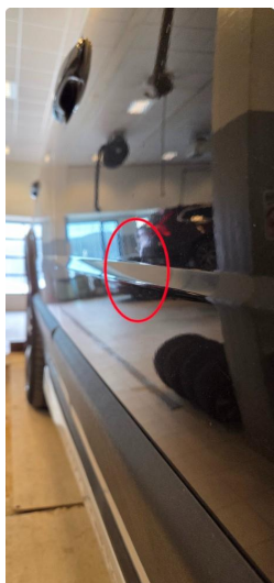
1.1 Små bulker på høyre sidedør
