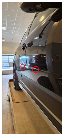
1.1 Små bulker på høyre sidedør
