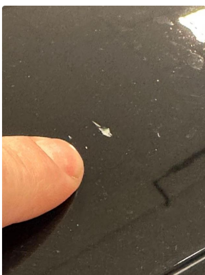
1.3 Liten steinsprut i forkant tak. Lakkeres forenklet
