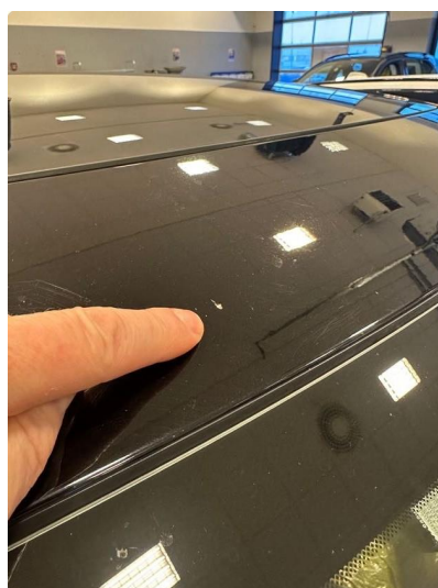
1.3 Liten steinsprut i forkant tak. Lakkeres forenklet
