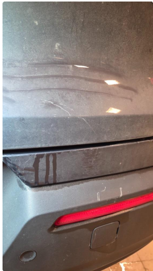
1.2 Flere små lakkskader på bakside og høyre side
