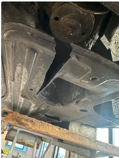
1.1 Sprekk i beskyttelsesplate under bilen
