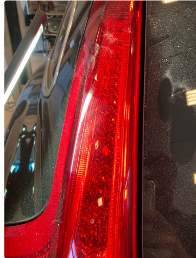
1.1 Litt krakelering i plast i venstre baklykt
