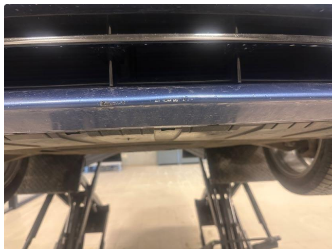
1.1 Litt oppripet på underside av fanger foran
