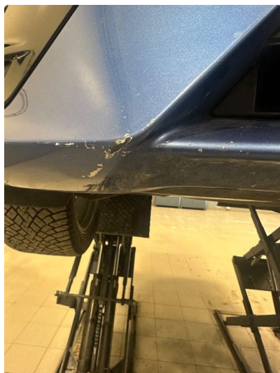
1.1 Litt oppripet på underside av fanger foran
