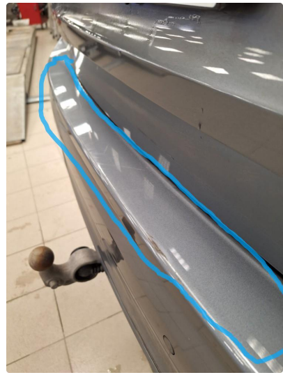
1.4 Noen riper i lastesone på fanger bak. Normal slitasje
