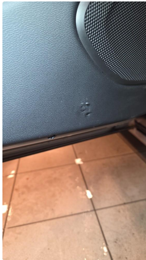
2.1 Noen merker i dørtrekk venstre bak
