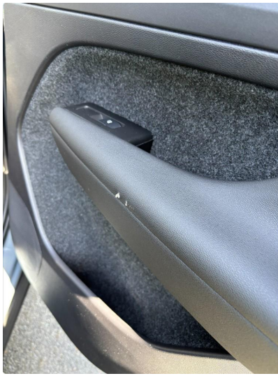
2.1 Liten rift i dørtrekk høyre side bak
