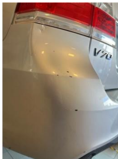
1.3 Noen riper/liten bulk i fanger venstre bak
