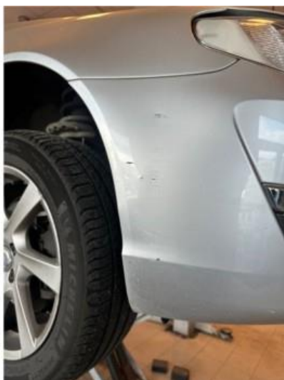
1.2 Noen riper/hakk i fanger høyre foran
