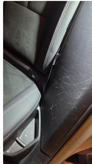
1.1 Noe slitasje etter bruk av barnestol
