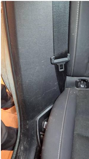
1.1 Noe slitasje etter bruk av barnestol
