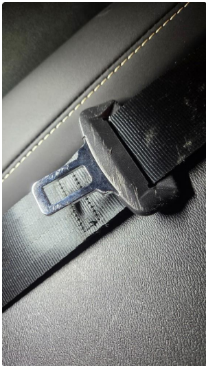
1.1 Noe slitasje etter bruk av barnestol
