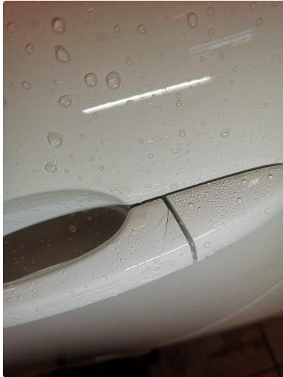
2.1 Små sprekker i lakk på alle fire dørhåndtak. Ubetydelig
