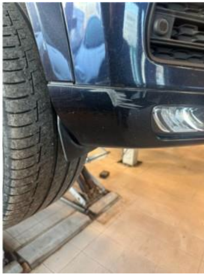
1.6 Litt oppripet på nedre del av fanger høyre foran
