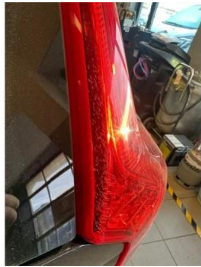
2.1 Litt krakelering i bremselys høyre bak
