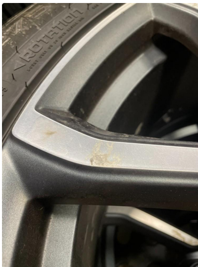
1.3 Ubetydelige lakkskader på 3 stk vinterfelger
