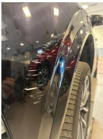
1.4 Noen riper i skjermutbygger og fanger venstre foran
