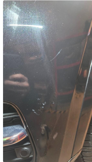
1.2 Liten lakkskade på støtfanger foran, høyre side
