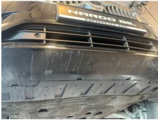
1.4 Litt oppripet på underside av fanger foran
