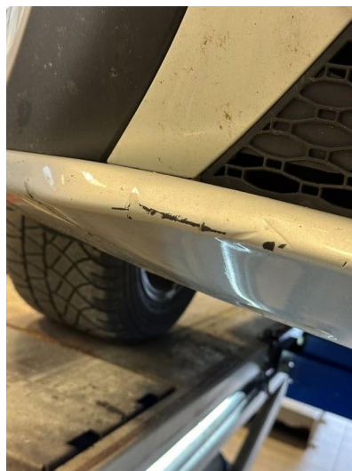
1.2 Noen hakk/riper i nedre del på fanger foran
