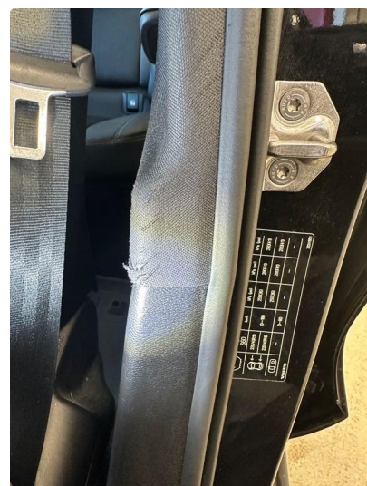
2.1 B-pilar-deksel litt slitt. Venstre side
