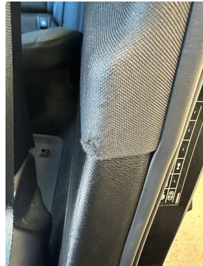
2.1 B-pilar-deksel litt slitt. Venstre side
