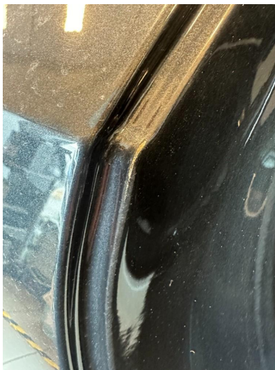
1.3 Noe slitt innsteg i døråpning begge bak
