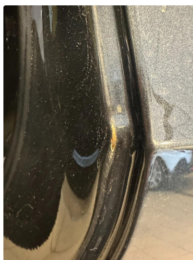
1.3 Noe slitt innsteg i døråpning begge bak
