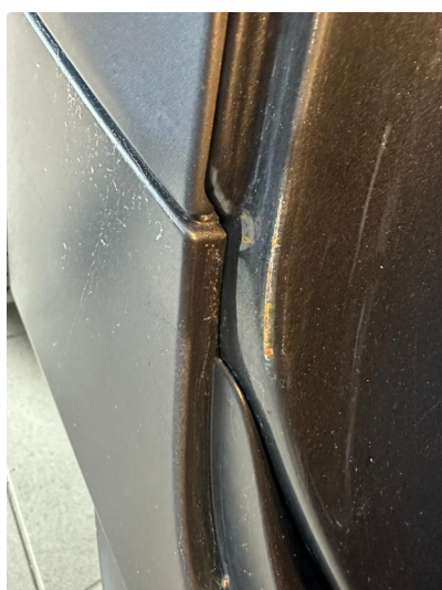
1.3 Noe slitt innsteg i døråpning begge bak
