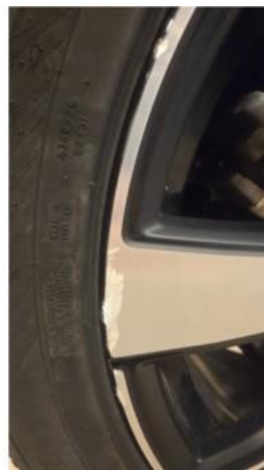
1.2 Noe kantkjørt vinterfelg høyre side bak
