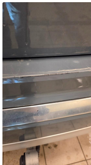
1.1 Riper på støtfanger bak
