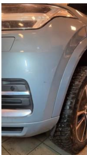
1.2 Små lakkskader på begge sider av støtfanger foran
