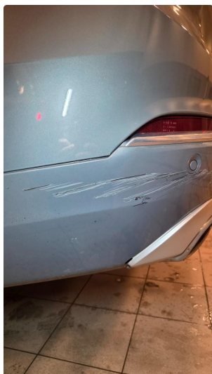
1.1 Riper på støtfanger bak
