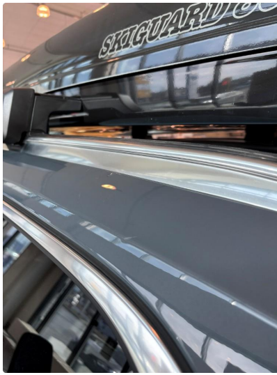
1.3 To små bulker og noe lakkskade, venstre side
