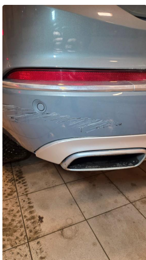
1.1 Riper på støtfanger bak
