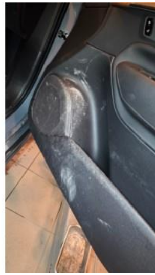
2.1 Merker på dørtrekk, høyre fordør
