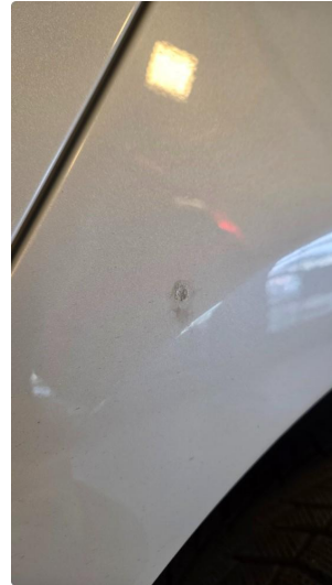
1.1 Tre steinsprut i lakk som er flekkklakkert; høyre forskjerm, førerdør og venstre bakskjerm
