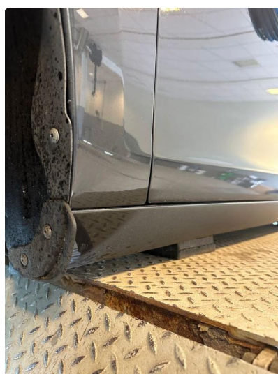
1.6 Noe matt/slitt lakk på på kanal foran begge sider
