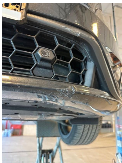
1.5 Litt oppripet på underside av fanger foran
