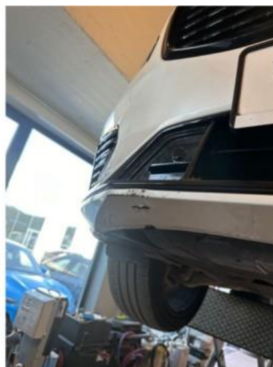
1.3 Litt oppripet på underside av fanger foran
