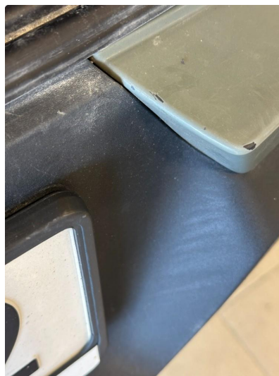
1.3 To små lakkskader ved innlastningssone
