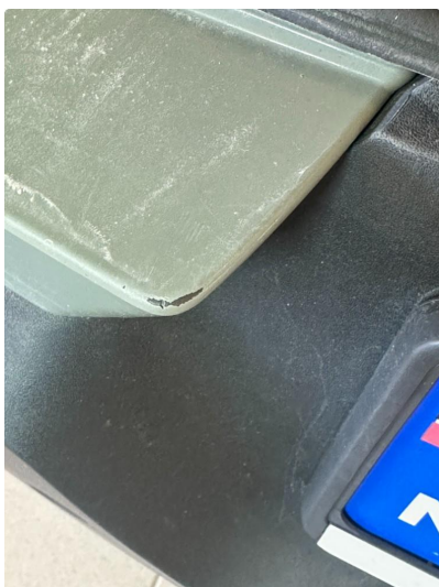
1.3 To små lakkskader ved innlastningssone
