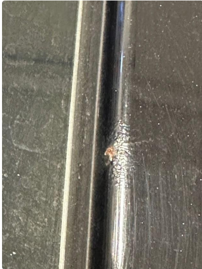
1.1 Lite steinsprut i forkant tak. Lakeres forenklet
