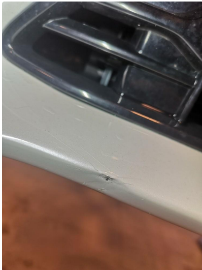
1.1 Liten skade i fanger høyre foran
