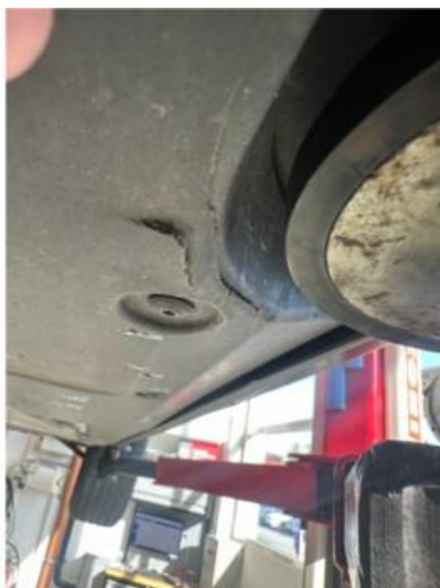
1.1 Noen sprekker i beskyttelsesplate under bilen. Normal slitasje
