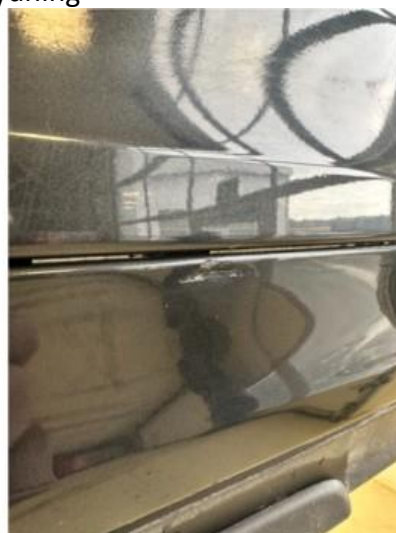
1.5 Liten bulk med lakkskade. Lakkert forenklet
