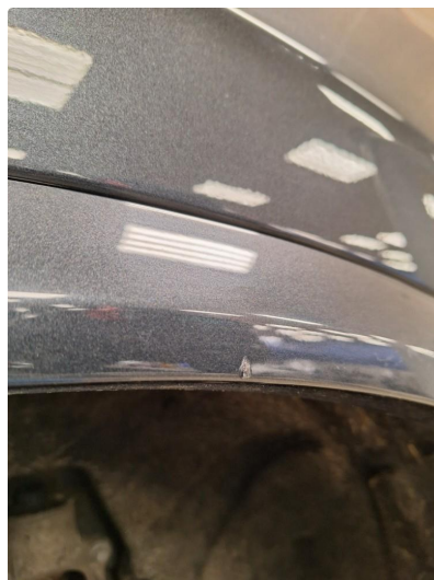
1.1 Noen riper/liten bulk på hjulbue venstre bak og noe riper på kanal venstre bak
