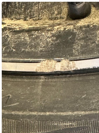
1.1 En vinterfelg litt kantkjørt
