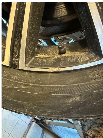
1.1 En vinterfelg litt kantkjørt
