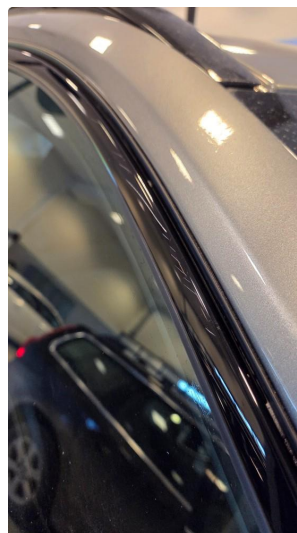
1.1 Små riper på vinduslister
