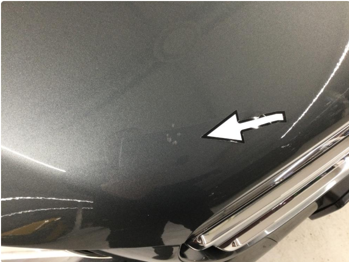
1.1 Steinsprut, Normal slitasje
