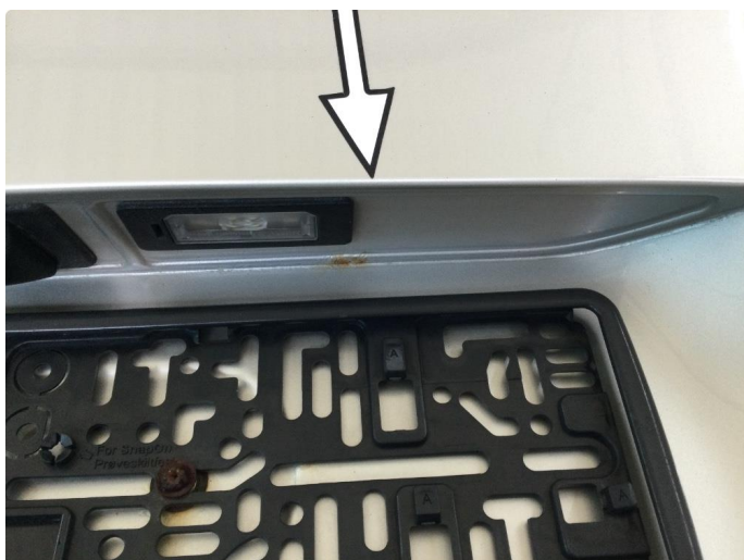
1.3 Rust i fals
