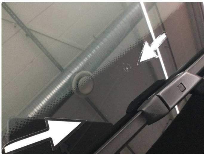
1.7 Steinsprut med sprekk
