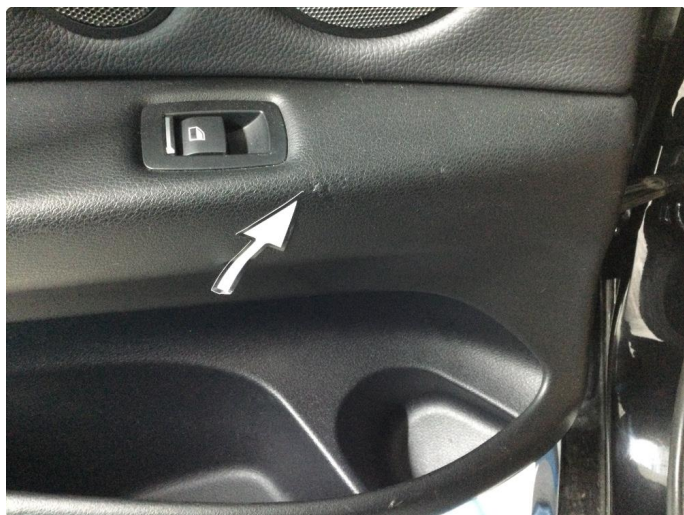
3.1 Skadet/merker etter utstyr
