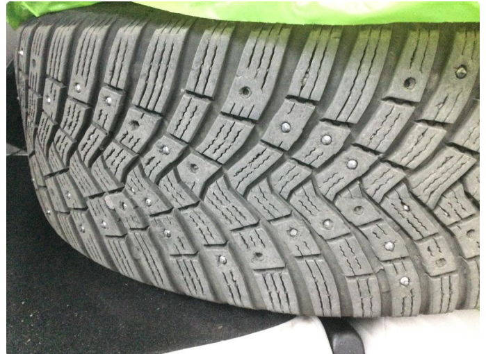
1.4 Piggdekk mangler pigger
