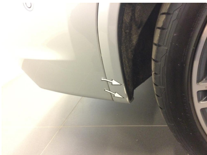
1.3 Ripe ned til grunning
