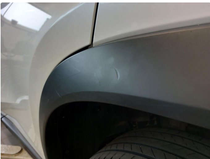
1.2 Liten skade på plast
