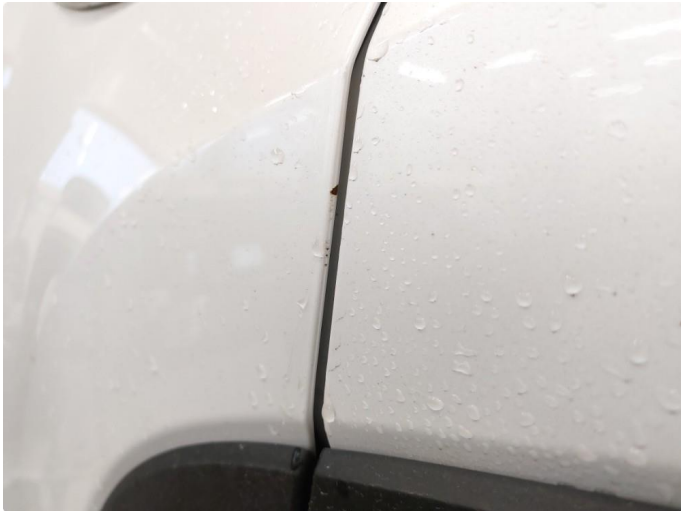
1.1 Steinsprut med litt rust
