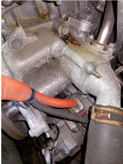
1.1 Kjølevannslekkasje fra vannpumpe
