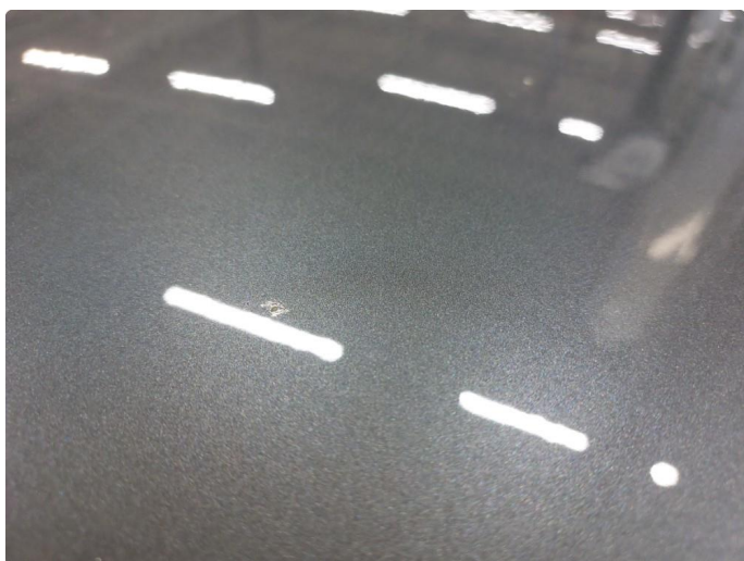
1.5 Steinsprut med litt rust
