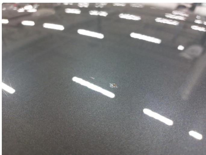
1.5 Steinsprut med litt rust
