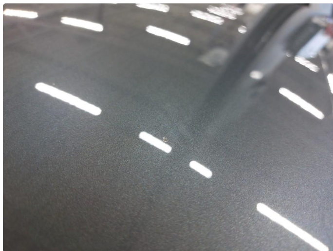
1.5 Steinsprut med litt rust
