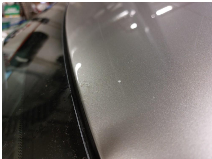
1.6 Steinsprut med rust
